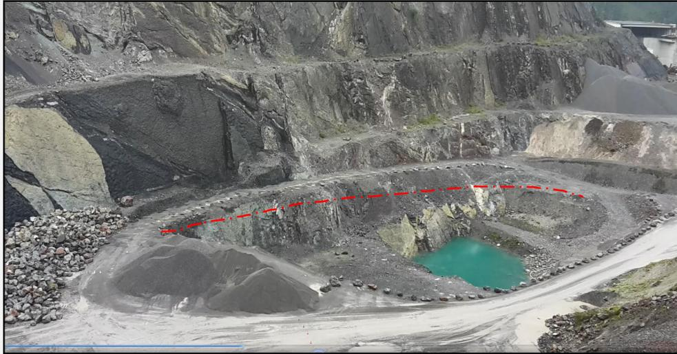
**Großbohrlochsprengung mit gleichzeitiger Sprengung eines Tiefgangs zur nächsten Sohle**
