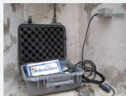
3. vibrometro in acquisizione
