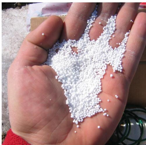
Sono miscele esplosive ottenute mescolando nitrato di ammonio prillato, privo di impurità, con granulometria minuta (0,8-2,5 mm) e con una giusta consistenza che determina il potere assorbente, con olio combustibile che nella classificazione italiana corrisponde al gasolio per motori diesel d'autotrazione+
