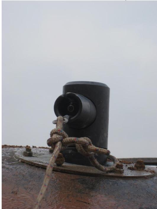
*posizionamento del sistema di innesco a percussione che viene armato da cordino a strappo*
