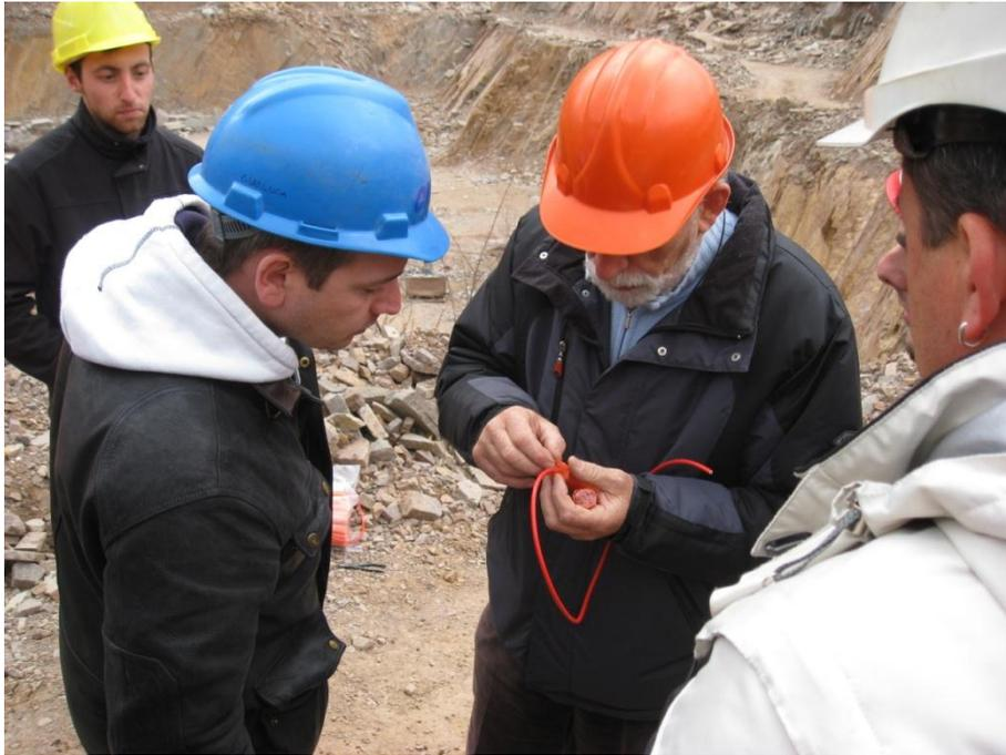
*Preparazione di una **%smorza+** con detonatore ordinario: introduzione della miccia armata*
