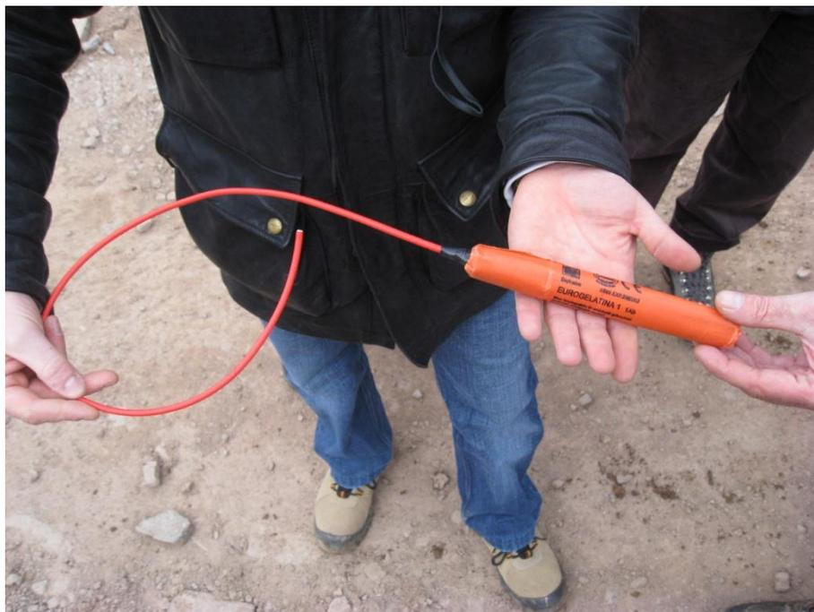
*Preparazione di una **%smorza+** con detonatore ordinario: fissaggio della miccia alla cartuccia.*
