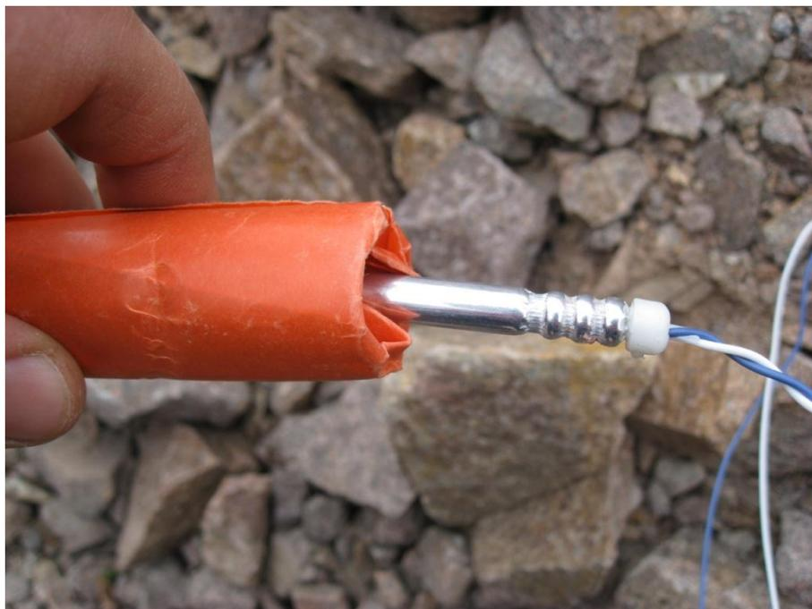
*Preparazione di smorza elettrica. inserimento del detonatore elettrico nella cartuccia di esplosivo*
