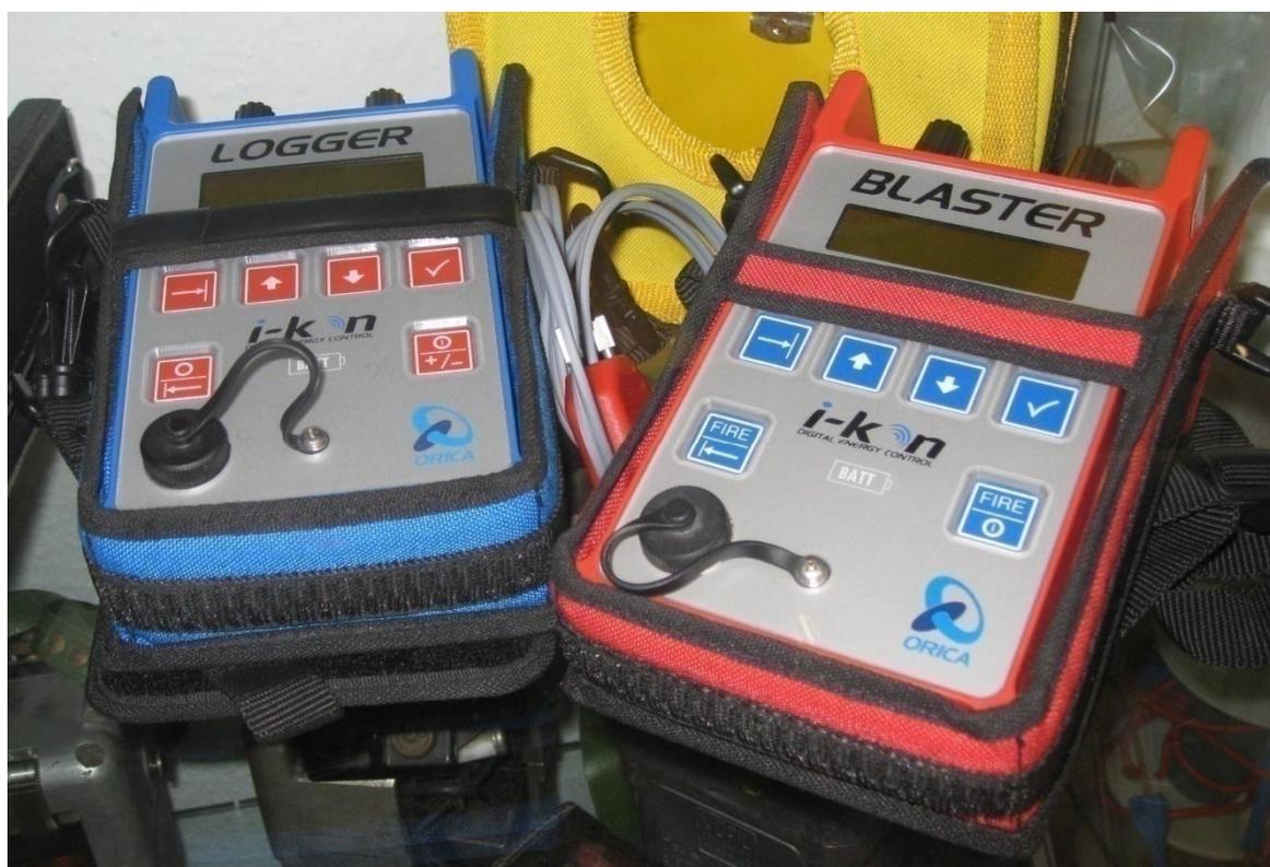
*apparecchiatura di programmazione (logger) e innesco (blaster) tipo I . kon®*
