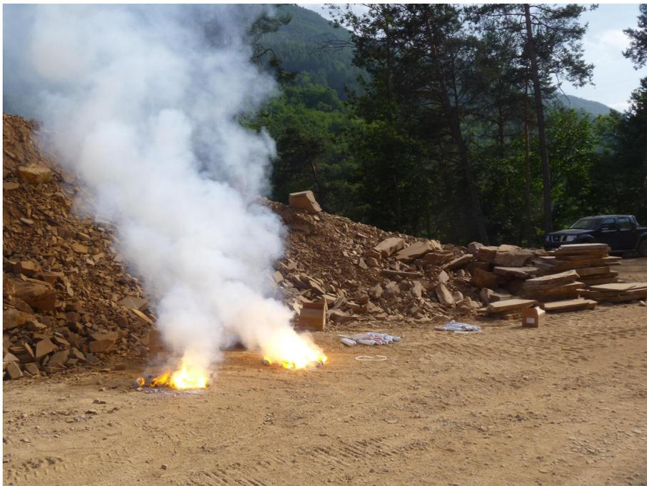
*Distruzione per combustione di esplosivo detonante suddiviso in piccole quantità*
