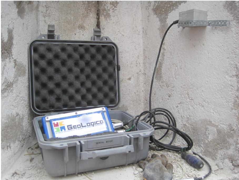
*Esempio di accoppiamento del supporto del trasduttore ad un muro di un edificio*
