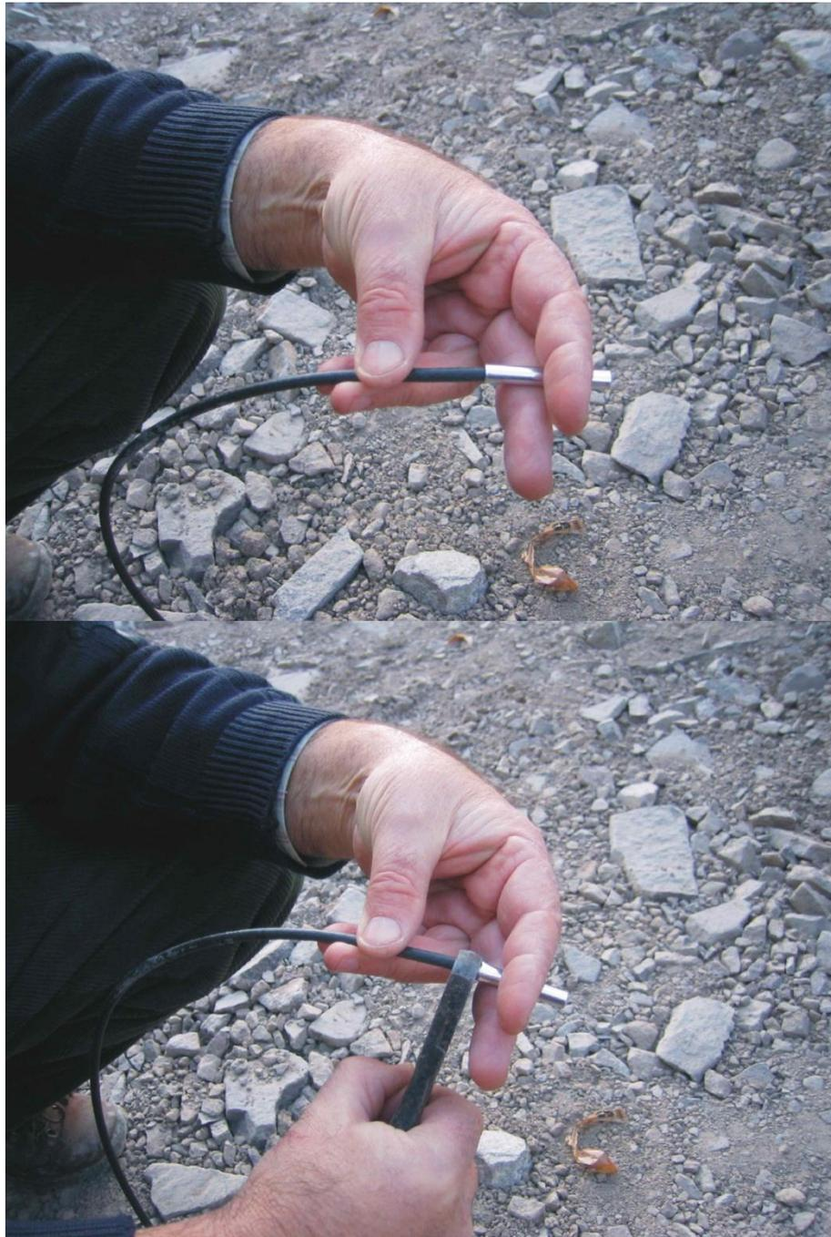
*Operazione di fissaggio del detonatore alla miccia a lenta combustione*
