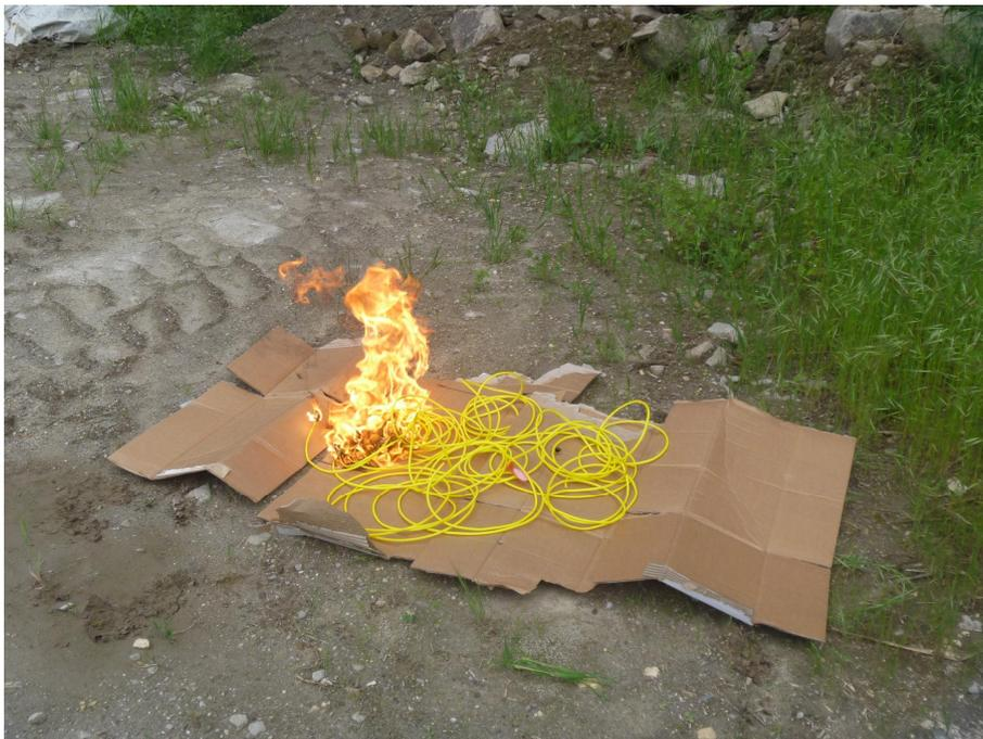
*Distruzione della miccia detonante*
