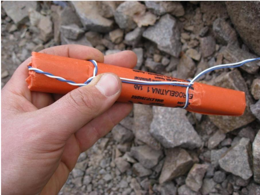
*Preparazione di «morza elettrica» fissaggio del detonatore alla cartuccia con l'utilizzo dei reofori*
