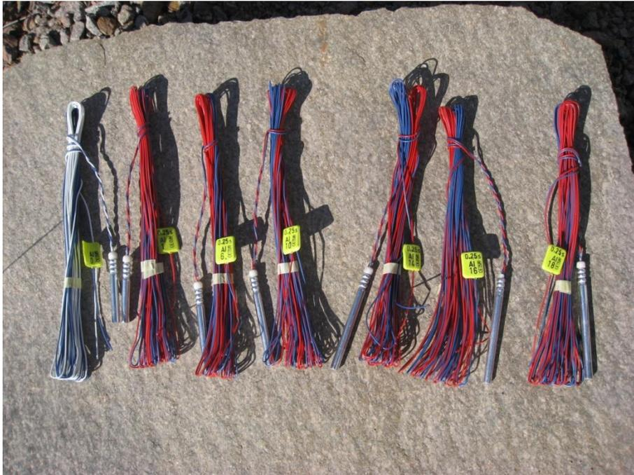
*detonatore elettrico istantaneo e detonatori elettrici ritardati*
